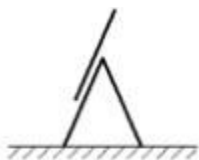
Obrázek 3 Kombinovaný žebřík ve volně stojící poloze s výsuvným žebříkem nahoře
